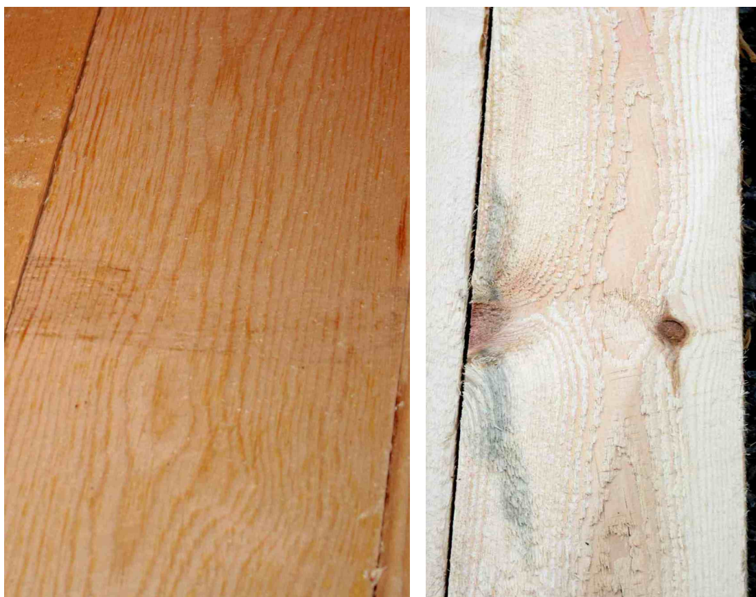
Øvre grense for synlige merker etter tørkestrø (bilde til venstre) og blåved (bilde til høyre)
